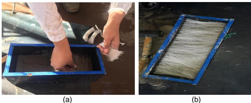
Figura 4 – Colocação das fibras (a) e fibras posicionadas (b)
