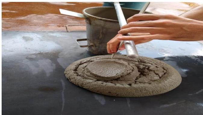
Figura 6 – Ensaio de consistência do concreto
