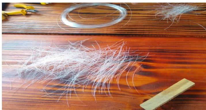
Figura 5 – Corte das fibras com estilete
