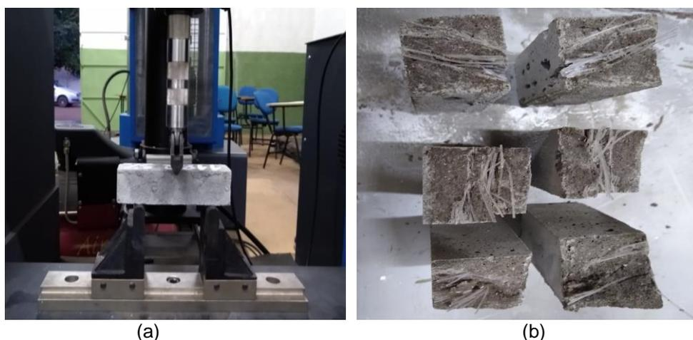
Figura 13 – Ensaio de tração na flexão (a) e corpos de prova rompidos a tração (b)
